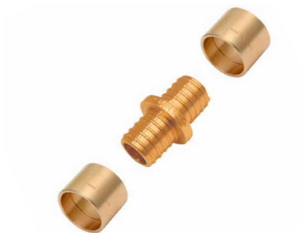
Rys. 43. Łącznik KAN-therm Push dla rur PE-Xc i PE-RT o średnicach 12 × 2, 14 × 2, 18 × 2, 18 × 2,5, 25 × 3,5
