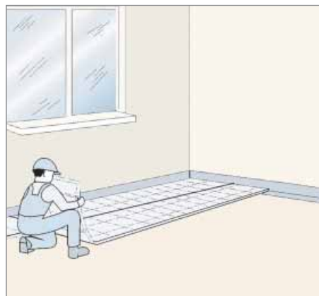
Se aplică plăcile de polistiren cu stratul de folie PE de asupra.
