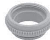
Adaptor M30x1,5 pentru servomotor electric ■ (culoare gri) - folosit pentru supapele termostactice ex. pe alimentatorul distribuitorului-colector cu unitate de amestecare seria 73A și 77A
