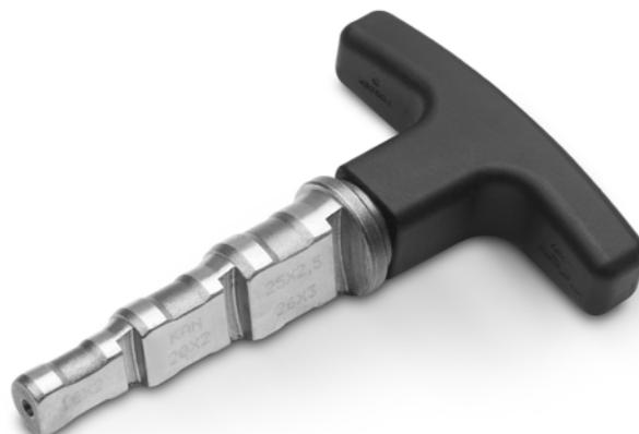
Calibratoare universale (multi-diametru): **16/20/25-26 mm, 25-26/32/40 mm, 50/63 mm**. În cazul fittingurilor ultraPRESS 16-32 mm, calibrarea nu este necesară, dar facilitează asamblarea.
