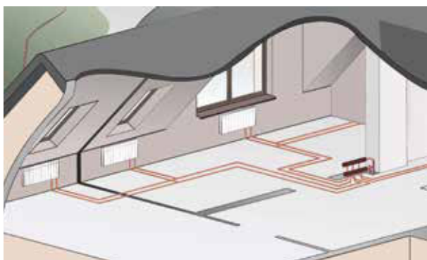
Sistemul de distribuitoare-teuri în instalațiile de încălzire
