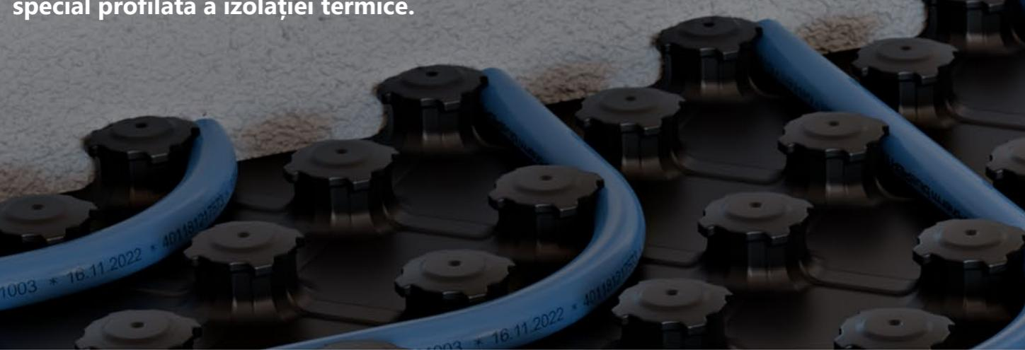
Structura instalației de încălzire prin pardoseală realizate din elementele sistemului KAN-therm Profil face parte din sistemele de încălzire prin pardoseală realizate în sistem umed. Elementele de fixare a țevilor de încălzire sunt proeminențe special profilate din plastic sau polistiren, amplasate pe suprafața izolației termice.
