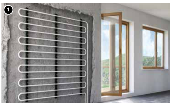
1. Încălzire/răcire prin pereți - construcție de tip A. 2. Încălzire/răcire murală - construcție de tip B.
