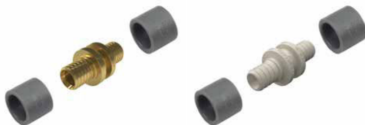
Fig. 50. Conector KAN-therm ultraLINE pentru țevi PEXC, PERT 2 și PERTAL 2 cu diametre de 14 x 2, 16 x 2,2, 20 x 2,8, 25 x 2,5 mm.
