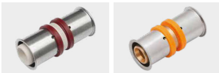
Fig. 51. Racord KAN-therm ultraPRESS pentru țevi PERTAL, PEXC, PERT, bluePERT și bluePERTAL cu diametre de 14 x 2, 16 x 2, 20 x 2, 25 x 2,5 mm.
